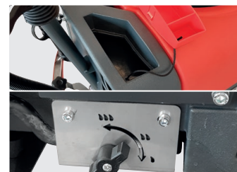
Einfüllöffnung Frischwassertank Wassermengenregler
